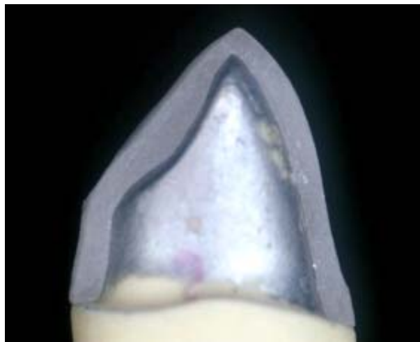
Abb. 7: Schnitt eines Carrara Press Core Käppchens mit einer Schichtdicke von 0,8 mm bis 1,0 mm.
