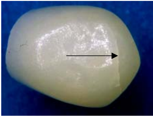
Abb. 23 / 24: Kronen mit Riss nach Termoschocktest bei 160° C
