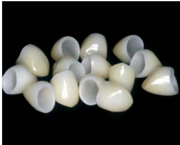
Abb. 8: Modellerte Kronen für den Bruchfestigkeitsversuch und den Thermoschocktest
