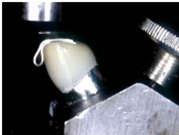
Abb. 12: Prüfanordnung mit Prüfkörper nach Voß
