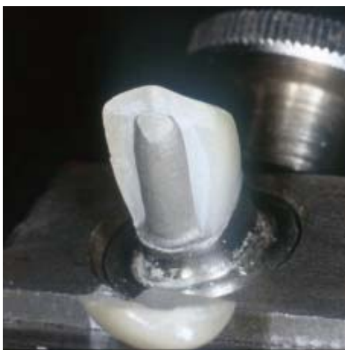
Abb. 16: Bruchfläche / Befestigung m. Panavia 21 ® ; Abb. 17: Bruchfläche / Befestigung m. ZnO
