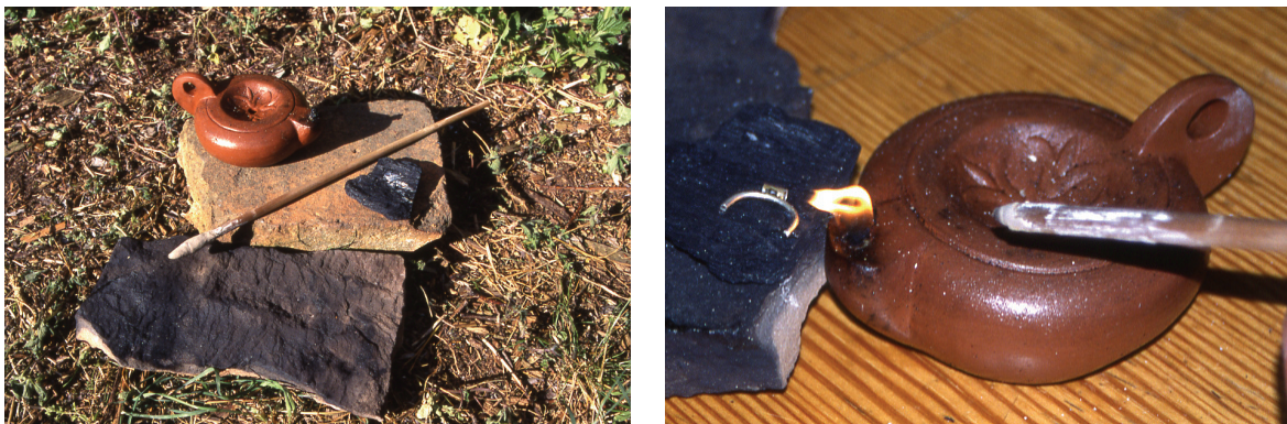
Abb. 51: Experiment zum Löten mit Öllampe, Blasrohr und Holzkohle.
