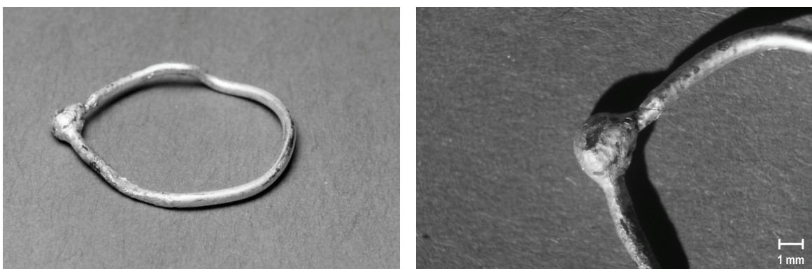
Abb. 44: Im Holzkohlefeuer verschweißte Drahttringenden (Ag 935).
