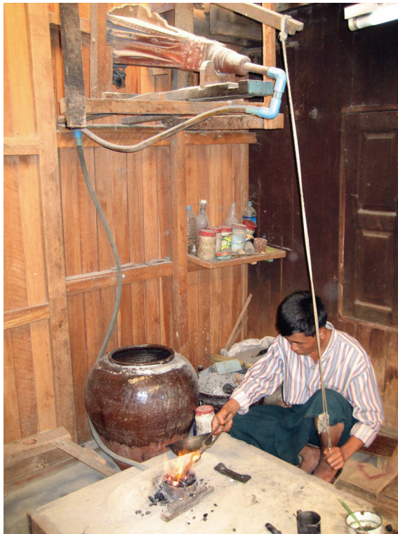
Abb. 47: Silberverarbeitung (Toreutik) in den Pfahlbauten des Inle Sees in Burma; Verwendung eines halben Keramikgefäßes als Schmelzofen. Der Gusstiegel in der Mitte wird über die seitliche Sauerstoffzufuhr von links auf Schmelz- bzw. Gießtemperatur erhitzt (Fotos: Manuela Fischer 2008).
