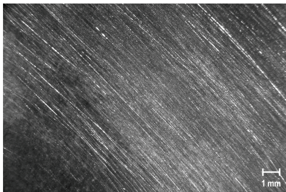
c: Spuren einer Drahtbürste
