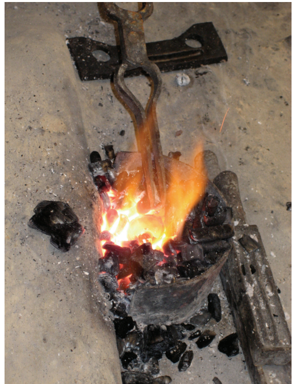
Abb. 47: Silberverarbeitung (Toreutik) in den Pfahlbauten des Inle Sees in Burma; Verwendung eines halben Keramikgefäßes als Schmelzofen. Der Gusstiegel in der Mitte wird über die seitliche Sauerstoffzufuhr von links auf Schmelz- bzw. Gießtemperatur erhitzt (Fotos: Manuela Fischer 2008).
