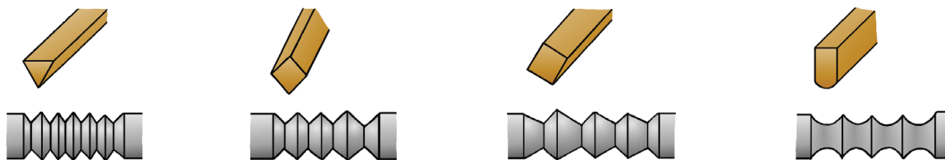
Abb. 20: Schemata zur Herstellung von Kerbdraht (Umzeichnungen nach Foltz 1989, 103 Abb. 4).
